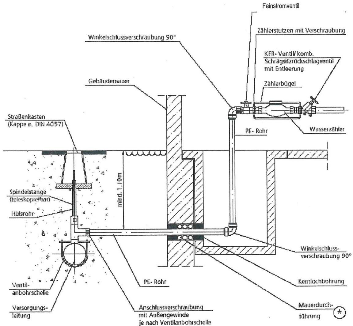
\* - Rohrdichtung mittels quellfähigem Dichtschlauch und Expansionsharz
